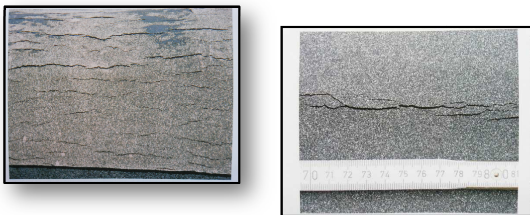
Obr.4.3 Krycí vrstva pásů z asfaltu modifikovaného SBS po skladování v chladu a po rozvinutí
